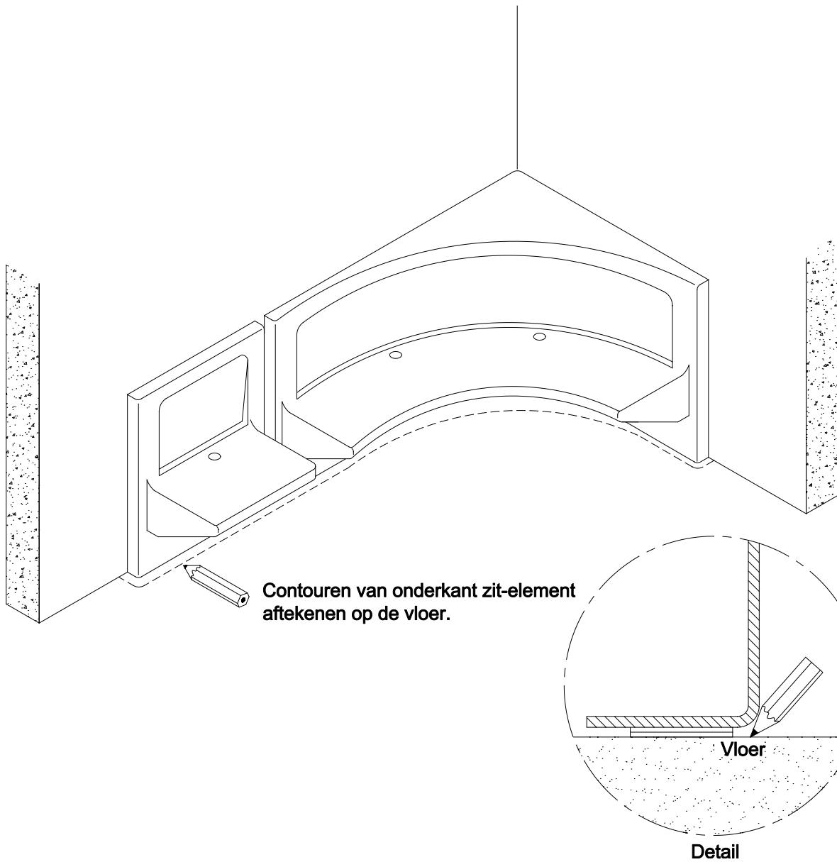
Stap 7: Til de elementen voorzichtig van de muur beugels. Zorg ervoor dat eventuele vulplaatjes op de juiste plaats blijven liggen en dat de muurbeugels en hoeksteen niet verschuiven. Draai de schroeven van de muurbeugels en hoeksteen stevig vast.
