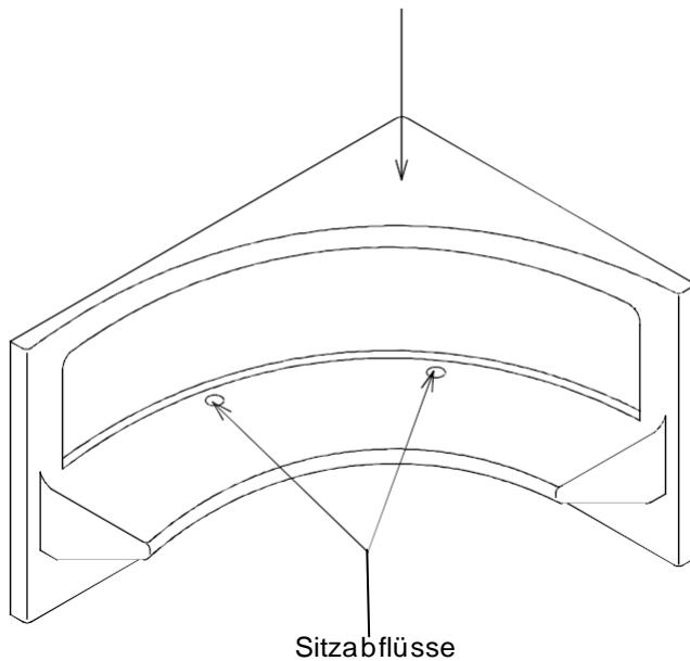
Die **maximale Tragkraft der Sitzelemente** beträgt 100 kg pro Einzelsitz.
