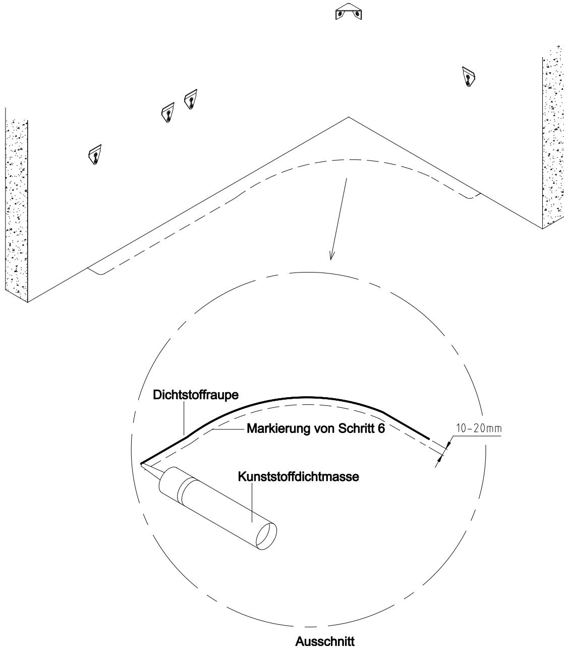
**Schritt 9** Reinigen Sie die Unterkante und die Seiten des Eckelements auf die Weise, wie der Hersteller des verwendeten Dichtmittels es angibt. **Verwenden Sie keinen Alkohol oder andere Chemikalien, um die Sitzelemente aus Acryl zu reinigen.** Hängen Sie das Eckelement ein. Stellen Sie sicher, dass die zwei Haken von der Rückseite des Eckelements richtig in die beiden Wandhalterungen eingreifen.
