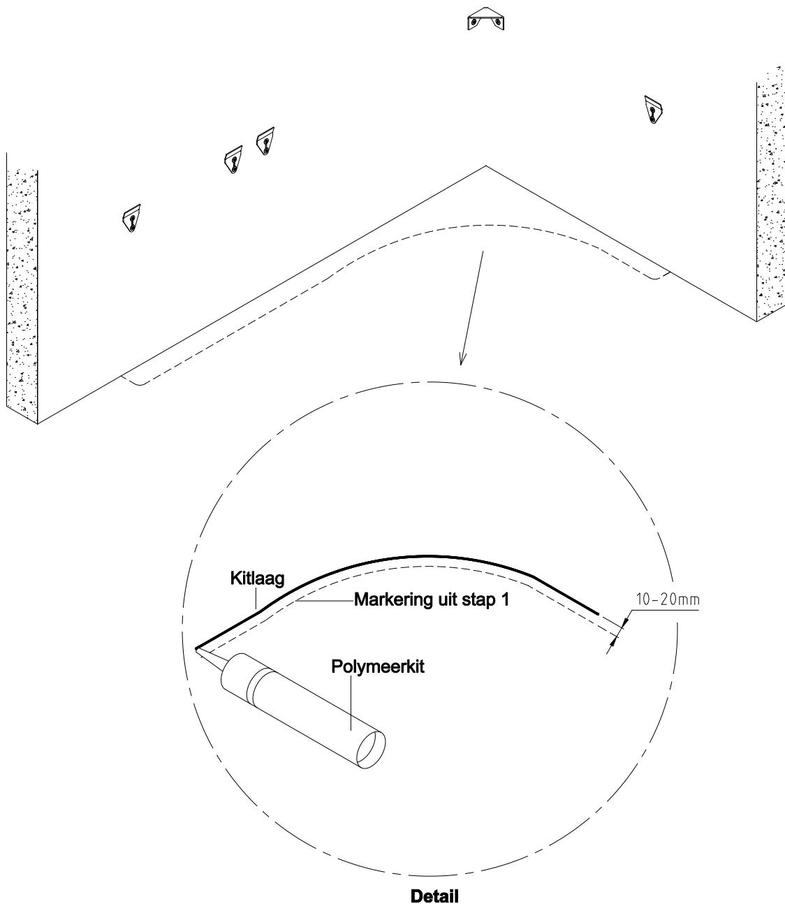
**Stap 9** : Reinig de onderkant en de zijkanten van het hoekelement zoals omschreven op de verpakking van de kit. Gebruik geen alcohol of andere chemische middelen om de acryl zitelementen te reinigen. Plaats het hoekelement.
