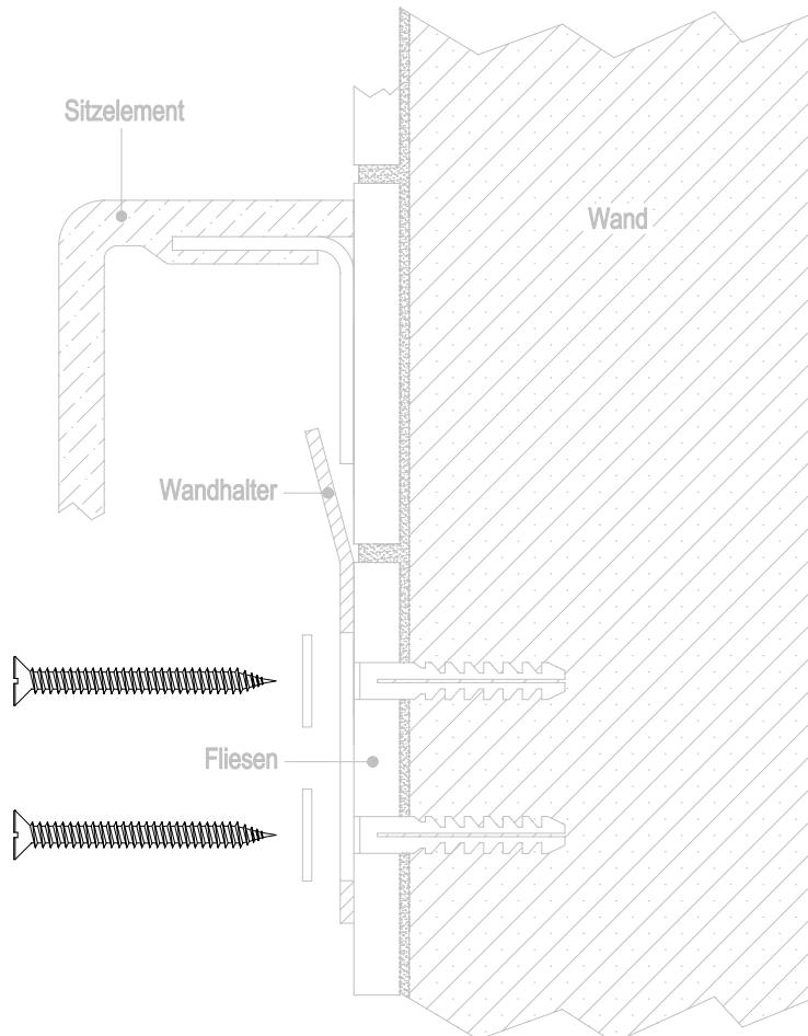
Die mitgelieferten Dübel sind für den Gebrauch in Beton- bzw. Vollziegelwänden geeignet. Bei einer davon abweichenden Wandbeschaffenheit sind entsprechend andere Dübel zu benutzen. Diese Dübel sind im Lieferumfang nicht enthalten.
