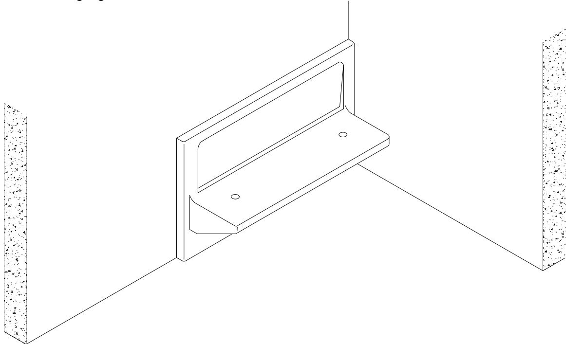
Zeichnen Sie die Bohrungpositionen an und bohren Sie Löcher 8 mm in die Wand.
