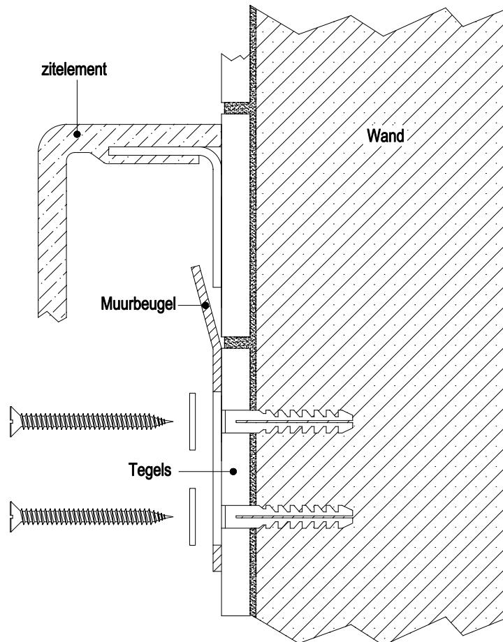
De meegeleverde pluggen zijn bedoeld voor gebruik in beton / volle steen wanden.
