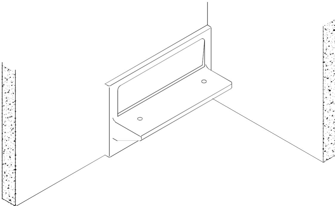
Aftekenen en boren van bevestigingsgaten Ø8mm in de wand
