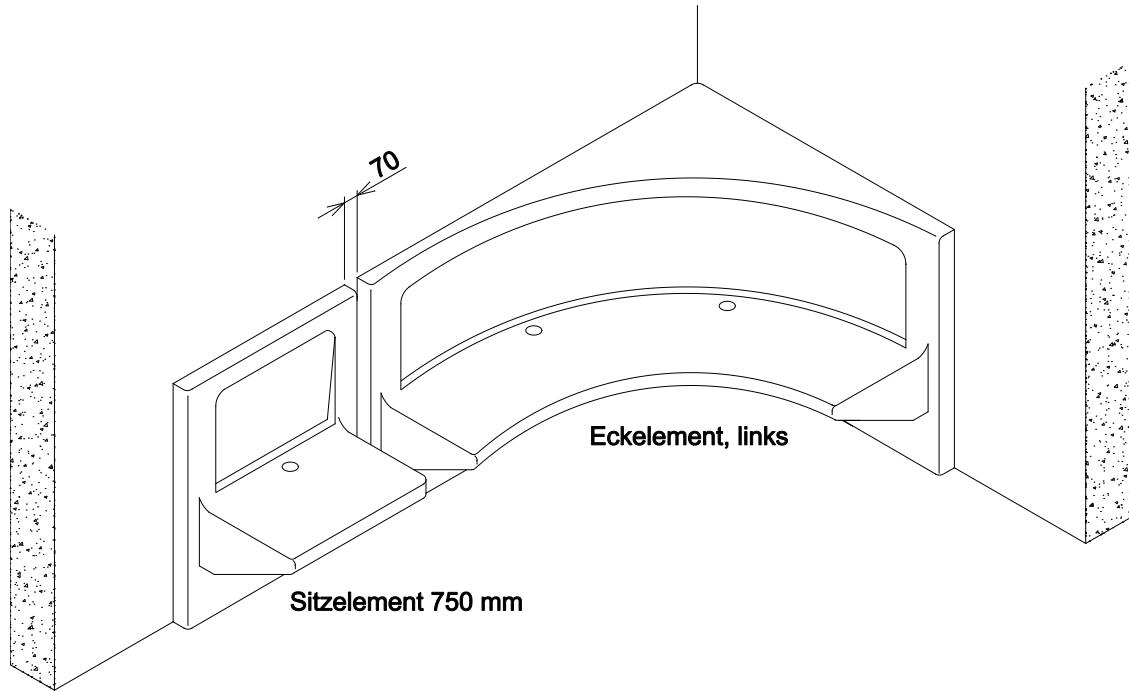
**Schritt 1** Zeichnen Sie die Position der Befestigungslöcher an der Wand an.
