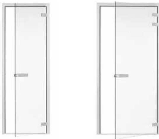
Uitvoering scharnieren voorstaand rechts
